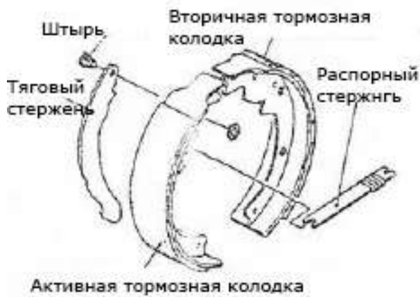
Рис.3-7 Устройство стояночного тормоза
